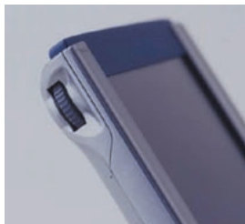
本体左側面のジョグダイヤル。上下回転とクリックが可能。左手でも右手でも操作できる
