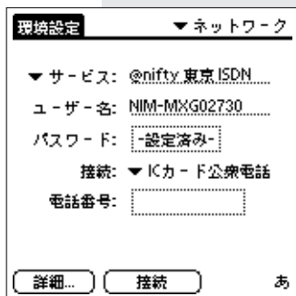
画面3-48 環境設定のネットワークパネル。プロバイダーの設定とISDN同期接続に対応したアクセスポイントの電話番号を入力し、接続方法は「ICカード公衆電話」を選択する
