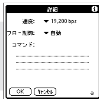
画面3-14 詳細設定では、速度とフロー制御を設定する。コマンドは未入力のみでいい
