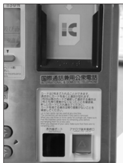
壁掛け型電話機の右側拡大写真。上部にICカードポケット、下部には赤外線ポートとアナログ端末接続口が並んでいる
