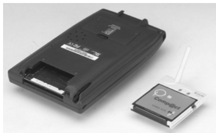
TRGproとP-in Comp@ct。TRGpro背面のCFカードスロットに、ほぼ収まる大きさだ
