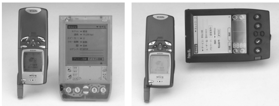
NM502iとVisorで赤外線通信を行う場合は、このPalm cの場合は上部に赤外線ポートが装備されているので、この向きで赤外線通信を行う
