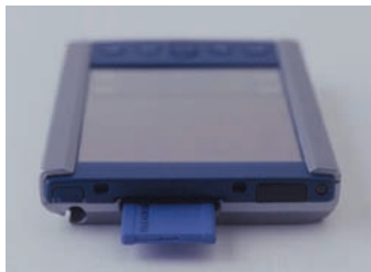
同梱の8MBメモリースティックを装着しているところ。別売の大容量メモリースティックも使用できる
