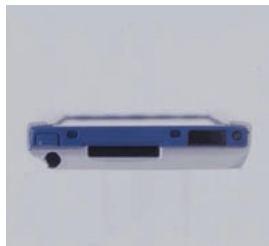
本体上部。赤外線ポート、メモリースティックスロット、電源ボタンが見える
