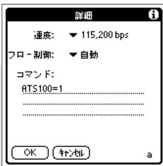
画面3-47 詳細設定画面。速度は「115,200bps」、フロー制御は「自動」、コマンドの欄には「ATS100=1」と入力する
