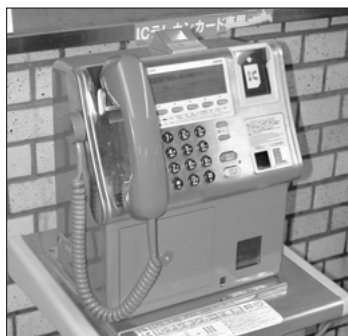
上部に小銭投入口が付けられた現在の主流型ICカード電話機
