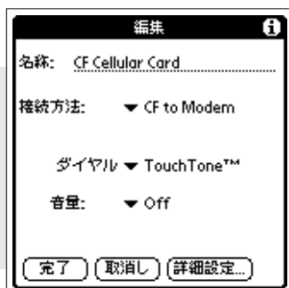
画面3-42 CFサイズの携帯電話通信カードの設定画面。接続方法は「CF to Modem」、ダイヤルは「TouchTone」を選択する
