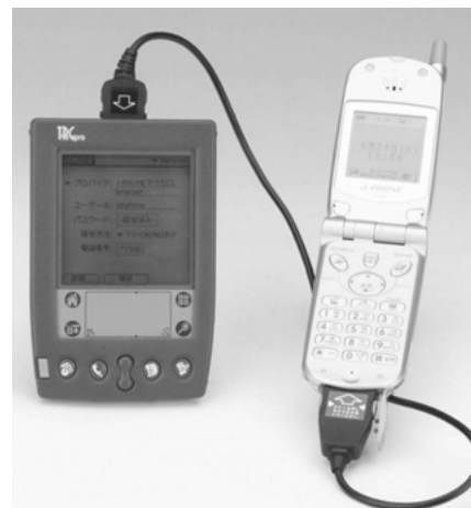
松下電器産業の携帯電話通信カード「TO-CAD9628CF」で、TRGproと携帯電話を接続したところ
