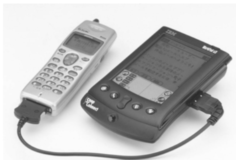
SnapConnect c3を使って、WorkPad c3と携帯電話を接続したところ
