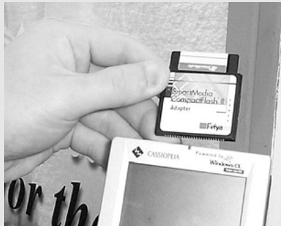
Feiya Technology社の一見、CFメモリーのようなスマートメディアとCFの変換アダプター。特別なドライバー不要で、CFスロットがあれば使用可能とのことだ
