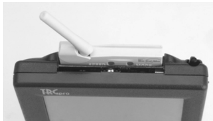
拡大してみると、CFスロット開口部の基板の一部や赤外線受光部が露出したままとなる
