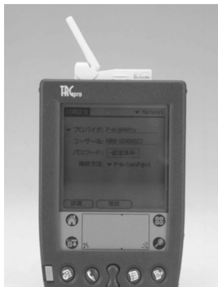
TRGproのCFカードスロットに、P-in Comp@ctを装着したところ。アンテナ部分が若干飛び出す、非常にコンパクトだ
