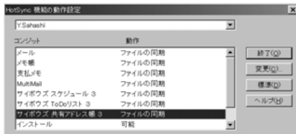
画面2 HotSyncマネージャーの「動作設定」にサイボウズの3種類のコンジットが追加されている
