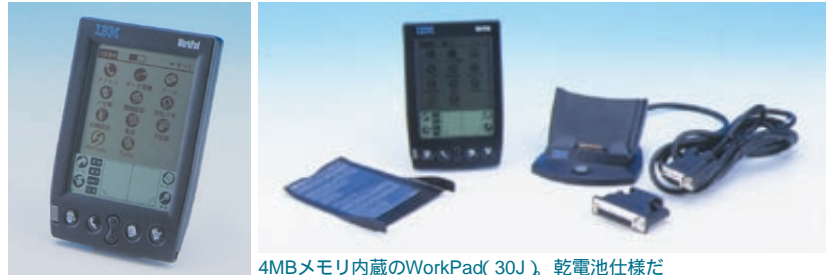
4MBメモリ内蔵のWorkPad(30J)。乾電池仕様だ
