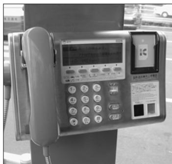
電話ボックスなどを中心に配置された壁掛け型のICカード公衆電話。IrDA接続窓はひとつしか搭載していない
