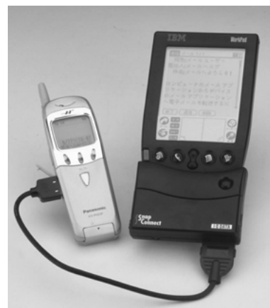
SnapConnectを使って、WorkPad(30J)とH 1 端末を接続したところ
