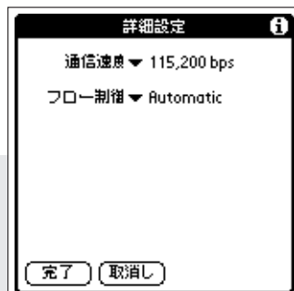
画面3-37 接続の詳細設定画面では、通信速度を「115,200bps」、フロー制御を「Automatic」と選択する
