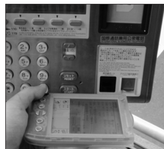
Visorの場合は赤外線ポートが側面にあるので、通信中は横向きに操作しなければならない
