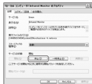
図8 ワイヤレスリンクを使わないように設定してもHotSyncできない場合、Infrared Monitorが影響している可能性がある。HotSyncをする前にサービスを停止しておこう
