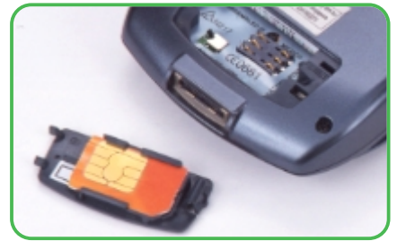
写真1 背面のふたを開けると、GSM方式の通信で使われるSIMカード装着スペースが現れる。米国では3月19日に米ハンドスプリング社と米スプリント社の提携が発表され、CDMA方式対応の開発も始まっている
