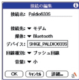
図3 Bluetoothモデム機器にダイヤルアップ接続するには、「環境設定」の「接続」で、あらかじめ機器同士のリンクを確立しておく
