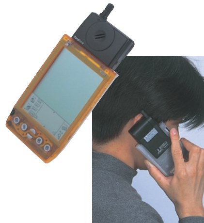
写真2 モジュールにはバッテリーとスピーカーが内蔵されており、厚くて長い作りだ
