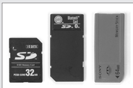
写真 Palm Bluetooth カード(中)は、通常のSDカード(左)より2cm弱、縦長だ。右はメモリスティック
