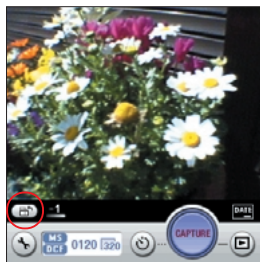
図1 CLIEを横位置で構えて撮影するときは、赤く囲まれたボタンをタップすれば撮影画面が90度回転し、横長の画像として記録できる
