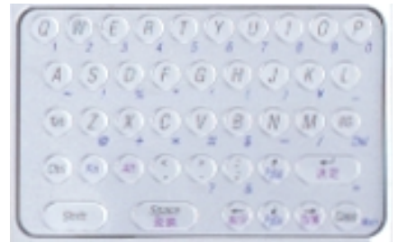
写真1 アルファベットの大文字の入力はShiftキーを押しながら行う。しかし、「@」を入力するにはFnキーを押しながら「Z」も押すなど改善点も見られる
