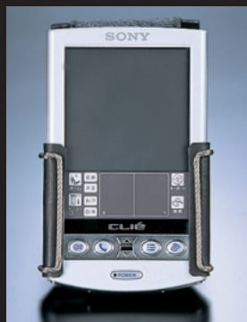
写真2 CLIEの固定は、正面両側のワイヤーのほか、背面のラッチと裏面下部の反り返しによって実現している。非常に精緻な設計だ
