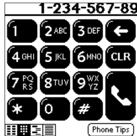
図3 アルファベット入力がデータと一致しない場合、自動的にテンキーモードに変更され、入力したボタン操作が引き継がれる
