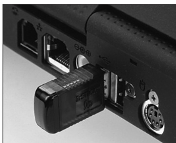
図6 「IrSTICK」はUSBコネクタ一体型の赤外線アダプター。この指先ほどのサイズしかない小さなデバイスが、Palmとノート型パソコンの赤外線HotSyncを可能にする
