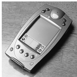
導入された株式会社オリンパスシンボルの「SPT1746」。バーコードリーダー、スキャナーが内蔵され、かつ無線LANを使える、PalmOS搭載機なのだ
