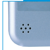
写真2 背面から見て左下のコーナーには、MP3/ATRAC3形式のオーディオやアラームサウンドを出力するスピーカーが実装されている
