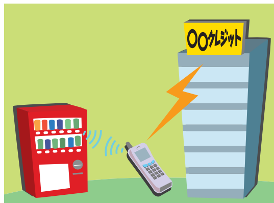
図4 Bluetooth内蔵携帯電話を持っている場合、同規格内蔵の自動販売機で購入ボタンを押すと携帯電話は電話会社と接続し、口座決済を行う。決済完了後、携帯電話は自動販売機に商品を出すよう命令を送る、といった具合だ
