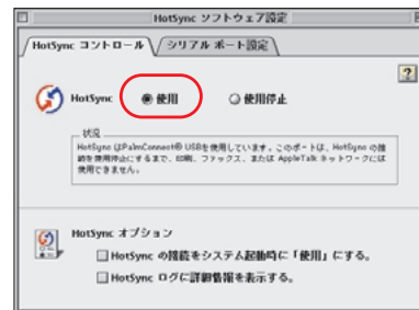
図3 Palm Desktop 2.6.3の「HotSyncオプション」のチェックは外しておき、OS 9上でHotSyncするときはHotSyncを手動で「使用」にするとトラブルがない
