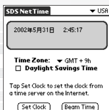
図4 [Set Clock]ボタンをタップすることで、指定されているNTPサーバから世界標準時を取得して内蔵時計の狂いを調整する。指示通り4つのジャンルを適当に設定するだけでいい
