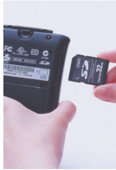
写真 本体の背面には必ず、SDカードスロットのそばにカードの向きを示したマークが表示してあるので、よく確認してみよう
