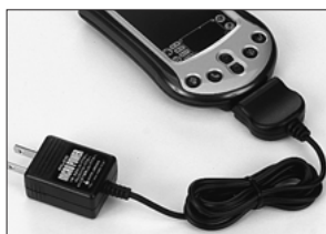
図5 Palm 付属のACアダプターは、その多くがクレードル経由でなければ接続できない。「マイクロパワー」などを使うと、Palm に直接つないで充電できる
