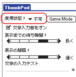
図2 外付けキーボードを動作させるためには、専用のソフトをインストールしているはずだ。データ通信と共存できない場合は、キーボードのドライバをオフにする
