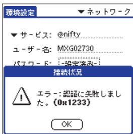
図3 グラフィティ入力に慣れていないうちに陥りやすい認証エラー。ダイヤルアップ時のユーザー名やパスワードが間違っているときに発生する
