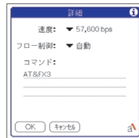
図5 ほとんどのアナログモデムは、初期状態ではダイヤルトーンを検出してからダイヤルする設定がなされている。内線発信をするには、コマンドを「AT&FX3」に変更すればいい
