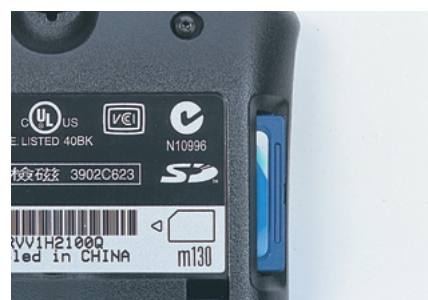
写真4 SDカードは少し頭が飛び出した状態でセットされる。カードを押し込むと、ばね仕掛けでイジェクトされる仕組みになっている
