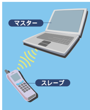
図1 通信を制御するのが「マスター」、管理される側が「スレーブ」だ
