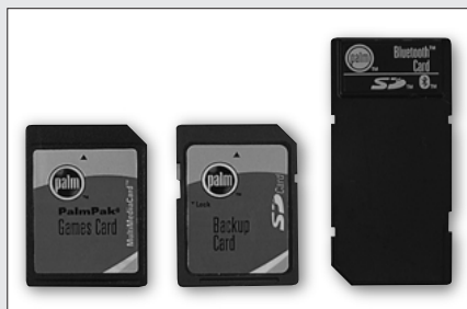
図1 SDカード(中)はMMCカード(左)に比べて端子(裏面)が多く、0.7ミリほど厚い。店頭価格はほぼ同じ
