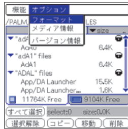
図4 メモリースティックは、必ず使用する機器でフォーマットするのが鉄則だ。再生がうまくいかないときは、MS Gateでメモリースティックをフォーマットし直してみよう
