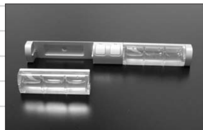
同社のノートパソコン「FIVA」と、FIVA用燃料電池のモックアップ。メタノールなどの燃料が見えるように透明の容器になっている。手前のチップがマイクロリアクターと水素型発電セル(左写真)
