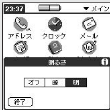
図2 図1のフロントライト調節アイコンをタップすることで、明るさを2段階で調節できる
