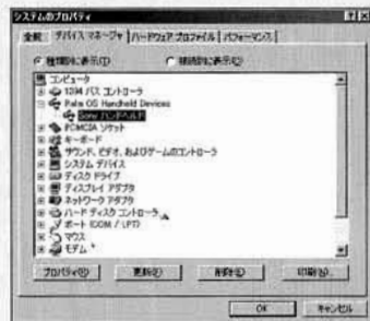
「デバイスマネージャ」の一覧に「Palm OS Handheld Devices」(USBアイコン付き)があれば、ドライバーは正しくインストール済み
