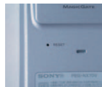
図 「RESET」と書かれた左の小さな穴がリセットボタンだ。ねじ式のピンになっている標準スタイルの上部や、クリップなどを使おう
