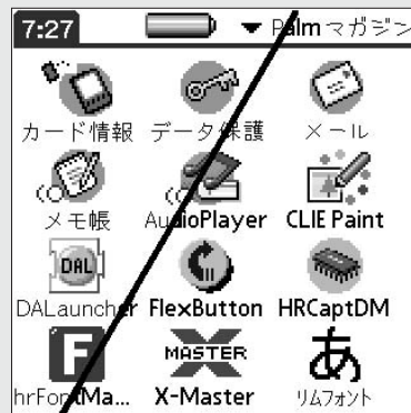
図2 斜線の左側がCLIEの標準、右側が「遊び文字」フォントと「Palm OS5」フォントの両方を指定したものの、視認性が大きく向上する
