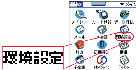
図2 解像度160×160ドットを採用しているPalm m515の画面。アイコンや文字を拡大すると粗さが目立つ
