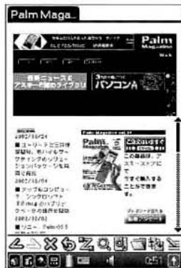
図 Palm MagazineのWebサイトをNetFrontで表示したところ。「ジャストフィットモード」では、画像とテキストが画面に納まるようにレイアウトされる
