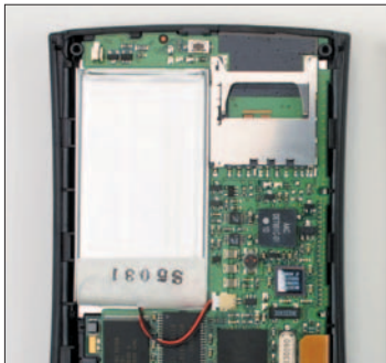
写真 Palm m515では、背面のフタを開けると左手にバッテリーが収納されている。近頃のデバイスはリチウムイオン電池がほとんど
