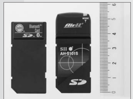
写真 Palm Bluetoothカードよりも約7ミリ長い。上部は約6ミリの厚さがあり、「MODE」のLEDは通信速度によって点灯する色が異なる
