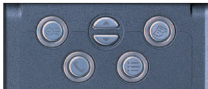
写真2 折り畳み式のデバイスであるCLIE NRシリーズより採用された、W型に並ぶハードウェアボタン
