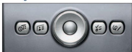
写真3 ボタンの配列はこれまでのPalmデバイスを踏襲しているが、上下スクロールキーがダイヤル型になった
