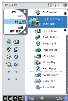
図 CLIE NXシリーズに搭載されたCLIE標準のアプリケーションランチャーは、これまでのホーム画面よりもジョグダイヤルの機能を最大限に生かせるような作りになっている
