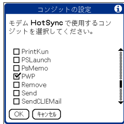
図2 PiloWebProのコンジツトのみ動作させるには、「オプション」メニューの「コンジツトの設定」で「PWP」だけをオンにする
