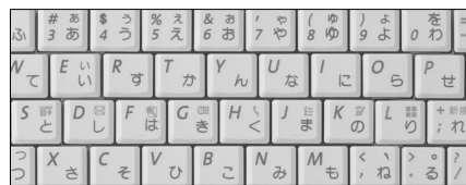
写真2 キーピッチはヨコ15.9ミリ、タテ約15ミリ。キーストロークは2ミリと、スペックはB5クラスのノートパソコンと同等。キートップはパンタグラフ式で小気味いい打ち心地だ
