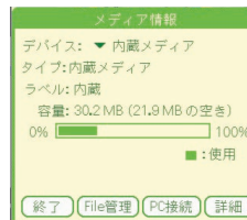
図2 ユーザーが実際に使用できる内蔵メディアは22MBまで。残りはプリインストールソフトに割り当てられている
