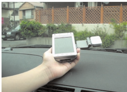
写真1 GPSアンテナは天空に向いていなければならないため、フロントウインドウ近辺でGPS衛星をキャッチ
