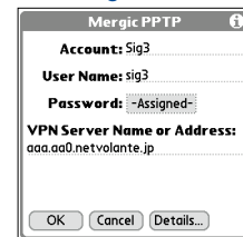
図1 PPTP接続するには、PPTPサーバー側で設定したユーザー名とパスワードを指定し、PPTPサーバーの名称かアドレスを指定すればいい
