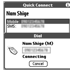
図3 Palm Tungsten Tでは、アドレスデータの表示画面で5-Wayナビゲーターの右ボタンを押すことで、Quick-Connect機能を利用して電話をかけることが可能だ
