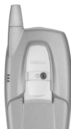
写真1 背面中央のシャッターを開けると、32万画素のCMOSカメラが現れる。残念ながら、撮影した静止画をPalm OSマシンにBluetoothや赤外線です送信する機能はないようだ
