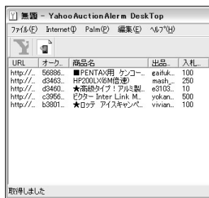
図 1 パソコン側で画面左上の「Y」アイコンをクリックしてウォッチリストを取得する。成功したら、右隣のアイコンで HotSync の予約を行う
