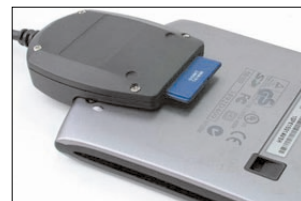
写真2 カードスロットはPalmの背面にあるのはHotSyncボタン。ドライバーのインストールは不要だ。同期・充電とカードの読み書きは別々
