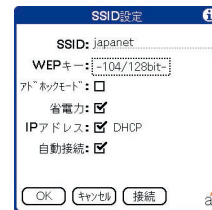
図3 アドホックモードやステルス機能でSSIDが隠されているアクセスポイントを利用するときは、新規にSSID設定を作成して手動で設定を行えばいい
