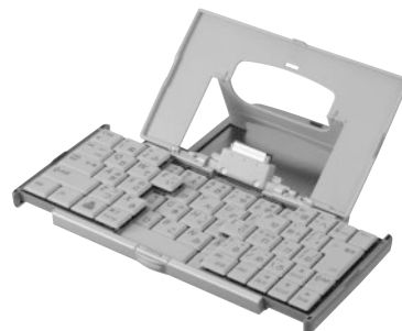
写真1 手前のボタンを押してフタを開け、コネクターを起こしてから両サイドをスライド。中央部分がせり上がったから両サイドを内方向に戻してコネクターにCLIEをセットする
