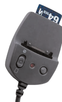
写真1 SD/MMC対応。右端にあるのはHotSyncボタン。ドライバーのインストールは不要だ
