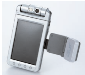
CLIEにメモリースティックGPSモジュールを装着。CLIE NX80VはこれまでのCLIEとは違い横にポートがある
