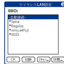
図2 ワイヤレスLAN設定画面には、登録したアクセスポイントの一覧が表示される。「自動接続」を選択しておけば、接続するアクセスポイントを手動で切り替える必要がなくなる
