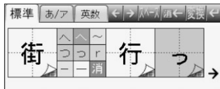
図1、2 手書き文字をその場で確定するため、視線の移動が少ない。マス目の右下をタップすると変換候補を表示する右端の「」がコミットボタンだ
