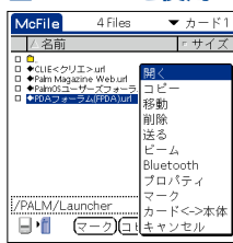
図2 「McFile」でインターネットショートカットファイルを関連づければ、メモリースティックに格納したファイルをそのまま利用できる
