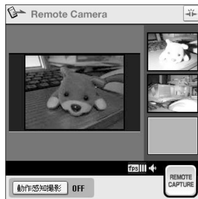
図 CLIE NZ90とTG50に搭載された「Remote Camera」を使うと、DSC-FX77を遠隔操作できる。離れた場所からシャッターを切ることが可能だ
