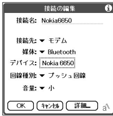
図1 「環境設定」の「接続」では「接続先」を「モデム」、「媒体」を「Bluetooth」とし、パスワードを交換してBluetoothリンクを作成。「詳細設定」では「速度」を「115200bps」、「フロー制御」を「自動」としてコマンドは空欄でOK
