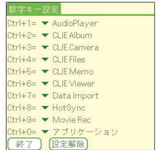
図3 「環境設定」の「拡張設定」で、「Ctrl」+「数字」キーに最大10個のソフトの起動を割り当てることできる。ハードボタンのようにカテゴリーの切り替えまでは機能しないが、少なくともハードボタンの代わりとして有効に活用できる
