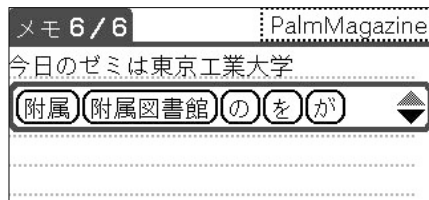
図1、2 一度入力確定した文字であれば、アルファベットを数文字入力するだけで変換候補を表示する
