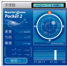
図1 GPS衛星は見つけるだけでなく、衛星からの電波を正しく受信する必要がある。電波をキャッチすると画面右下の棒グラフに入感レベルを示すグラフが表示される
