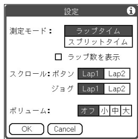
図2 計測結果のスクロールは、Lap1はジョグダイヤルで、Lap2は上下ボタンで、といったように別々の操作系を割り当てることができる
