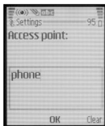
写真2 NOKIA 6650でデータ通信するには、あらかじめ電話機側でGPRSモデムの設定を行っておく必要がある。GPRS access pointの設定にて「phone」と指定すればいい
