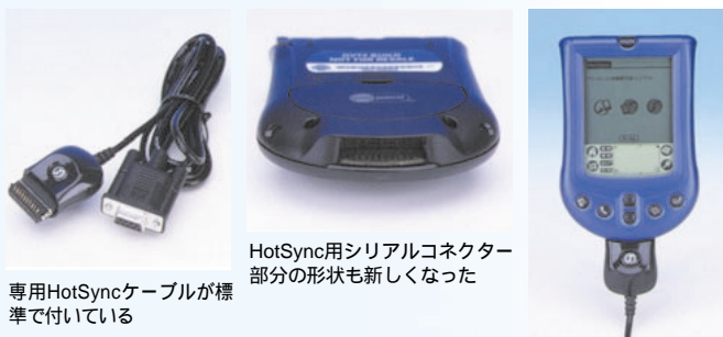
HotSyncケーブルを取り付けたところ。コネクタのボタンを押すと、HotSyncが始まる
