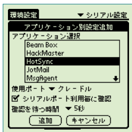
シリアル設定パネルのアプリケーション別設定追加画面で、個別の設定が追加できる
