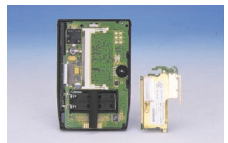
拡張スロットから、PHSユニットを外したところ
