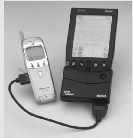
一般的なPalmデバイスでは、本体下部にモデムを装着して通信を行う
