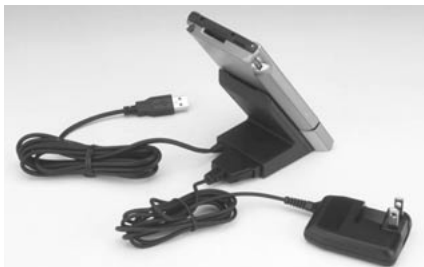
CLIEの場合は、クレードルの後部にACアダプターを接続できる
