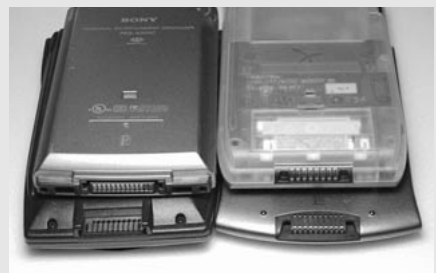
各種Palmデバイスのコネクタ形状の違い 左上 SONY CLIE PEG-S500C 左下 Palm c (Palm 、WorkPad 30J、TRGproなども同様) 右上 Visor 右下 Palm x (Palm V、WorkPad 40J/50Jも同様)
