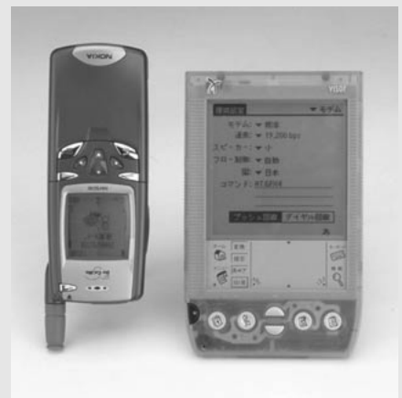
NM502iの場合は電話機側に赤外線ポートを装備しているので、Palmデバイスの赤外線ポートと向き合わせれば、ワイヤレス通信が可能だ
