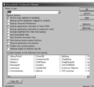
詳細設定の画面。画面のバックアップに関する各種設定が集約されている。設定次第でHotSyncにかかる時間を大幅に短縮できたり、効率を向上させることも可能だ
