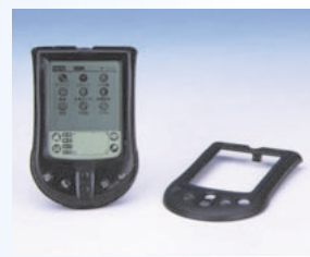
フェースプレートを外したところ。こちら工具なしでワンタッチで取り外しが可能
