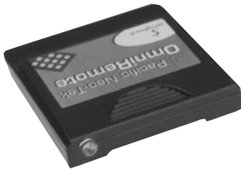
Visor本体の赤外線ポート以外に、強力なモジュール本体のポートも利用できる
