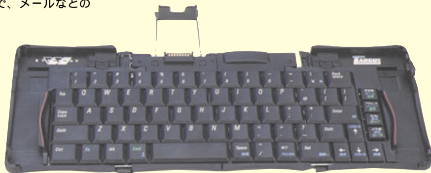
キーボードレスのハンドヘルド専用開発された「Targus Stowaway Portable Keyboard for Handspring Visor」。デスクトップ用とほぼ同等の大きさで、ノートパソコンのキーボードよりはるかに大きい。キータッチのサイズはかなり大きめで、ゆったりしている。なお、広げたときに中央部分がロックされず安定性に欠けるので、平らな場所に置いて使用するのが原則
