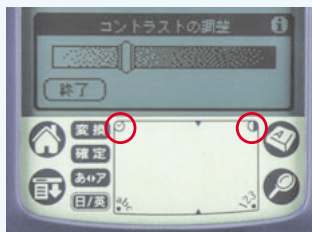
グラフィティ入力エリアの上部両サイドに増えたアイコン。左側が時計機能、右側がコントラスト調整機能だ
