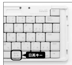
写真2 キーピッチは横18ミリ、縦17ミリ。キーストローク約2ミリ。キーの大きさは横17×縦16ミリでパソコン用とほぼ同じ。パンタグラフ式でクリック感もしっかりしている
