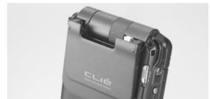
写真3 CLIE NX70Vでは通信カードのみの対応だったCFカードスロット。NX73V、NX80Vではメモリーカードにも対応したが、対応アプリケーションは、辞書やCLIE Mailといったテキスト系ソフトのみ
