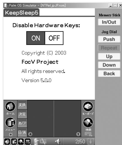
図2 Palm OS 5対応版では、シンプルにハードボタンの制御機能のみ搭載
