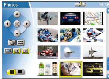
「Photos」で表示できるのはJPEG形式の静止画のみ。左の3つボタンで画像の場所(本体内の仮想カード、SDカード)を選択する
