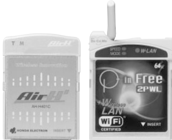
写真 DDIポケット(株)のAirH+(左)はベストエフォート方式で(フレックステンション方式ではベストエフォート方式と32kbpsポケット方式の組み合わせ)、(株)NTTドコモのPHSは64kbpsまたは32kbpsのギランティ方式だ
