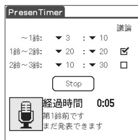
図1 マイクの絵やテキストなどで状況をひと目で把握できるPresentTimer。無音にしたり、音の鳴る回数を変えることも可能だ
