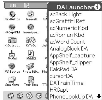
図1 Palm OS 5.2に正式対応した「DA Launcher」。ジョグダイヤルのほかに、左右ボタンによってDAリストのページを切り替えられるようになった
