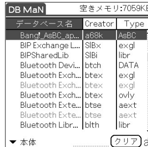
図1 メモリー上に存在しているアップデーターやパッチ。ファイルソフトを使うとその存在を確認できる
