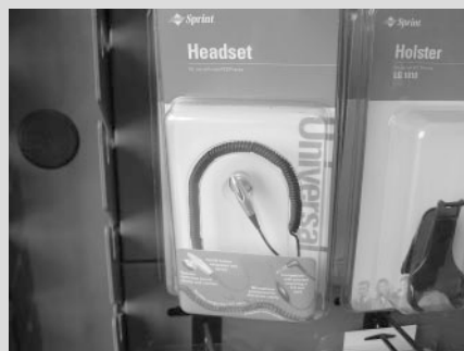
写真2 通話用のヘッドセット。一見するとイヤホンしかないようだが、コードの途中に小さなマイクが付いている
