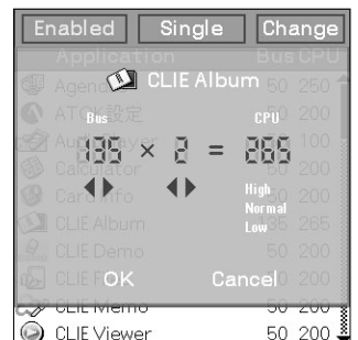
図2 「Lightspeed」の設定画面。アプリケーションの種類に合わせて、動作クロックをセッティングできる
