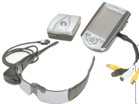
解像度240×320ドットのサングラス型ディスプレイ「Eyetop」NTSC/Pal出力に対応したポータブルDVDプレーヤーやデジタルカメラ、PDAとコントロールユニットを接続して使う。写真はHP iPAQ Pocket PCとの組み合わせ例。 価699.99ドル、圖仏アンジネオ社(圖 http://www.eyetop.net/home/default.asp )
