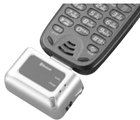
写真1 FOMAの携帯電話に接続するアダプター。Bluetoothを内蔵していないFOMA端末でもBluetooth経由でアクセスが可能になる
