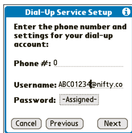
図1 携帯電話/パソコンとあらかじめパスワードを交換しておく。「Preferences」の「Network」でBluetoothでの携帯接続のためのISPを設定
