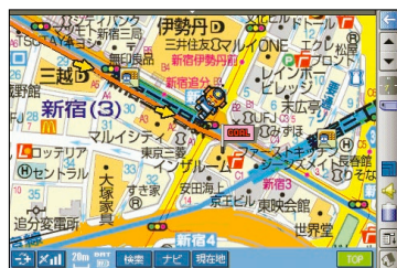
図5 現在地と目的地、中継地を設定してルート検索すれば、地図上にルート(道順)を表示できる。刻々と更新されるGPSの現在地情報と組み合わせ、移動中もリアルタイムでナビゲートする
