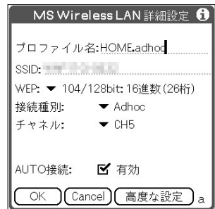
図2 環境設定に追加される「MS Wireless LAN詳細設定」では、SSIDやWEPの設定を行える。「高度な設定」ではIPアドレスやDNSの指定が可能で、「AUTO接続」を有効にすると、「AUTO」モードによる自動接続の対象になる
