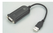
写真5 ウィンドウズ、マック両方で使えるUSBコネクタ。ウィンドウズはUSBドライバーが必要
