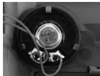
写真2 マイナスドライバーでゆっくりツメを曲げて慎重に外す。ツメを折らないように注意する
