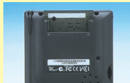
赤外線通信に干渉しない素材を用いた黒いカバーを取り外すと、赤外線受光部とCFスロットが現れる。カバーを開けているときは、ホコリなどに注意する。
