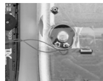
写真4 新ケースにはスピーカーの留め具がないが、セロハンテープなどで固定しておけばいい
