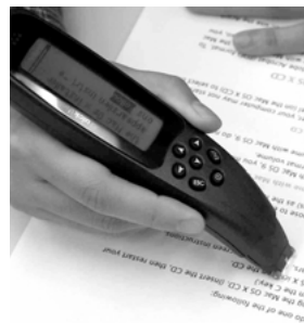
写真 ペンでなぞるようにスキャンするだけで、英文を次々と読み込める。スキャンしたデータを簡単にPalmへ転送できる
