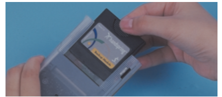
写真2 モジュールは背面のスプリングボードスロットに差し込む。電源のオン/オフにかかわらず使える
