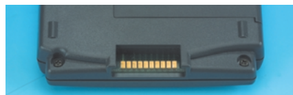
Palm Pilot 写真2 '97年に発売されたPalm Pilotのシリアルポート
