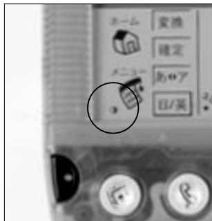
写真 小さく見づらいが、コントラストコントロールの位置は上図のとおり。製品によって位置は異なる。写真はVisor Deluxe
