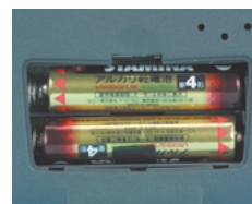
写真4 単4形乾電池を使っているので、バッテリーが切れてもすぐに調達できる
