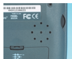
写真5 実はPalmデバイスの中で内蔵スピーカーが付いているのはTRGproだけ
