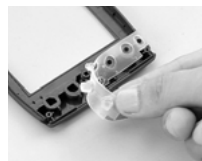
写真3 ボタンの裏に付いている端子を外す。これだけは、新ケースでも利用するので忘れずに
