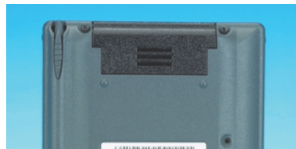
写真2 TRGproの背面上部には、CFカードスロットが用意されている
