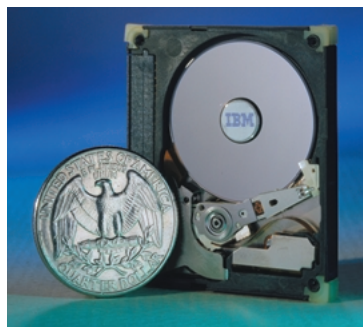
写真1 CFカードType I対応の容量1GBのハードディスクドライブ。価格は4万9800円（☎0120-041992）
