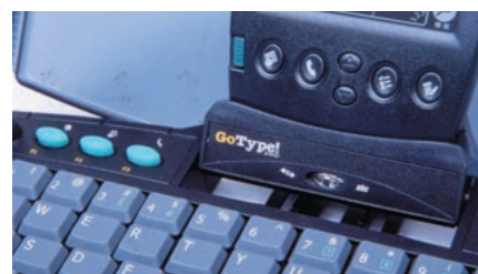
Palmの差込口の下には、クレードル機能とキーボード機能の切り替えスイッチがある
