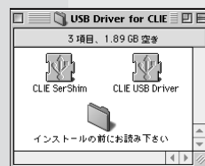
図3 左図の機能拡張書類をシステムフォルダへ、再起動後、マックとCLIEのHotSyncが実現する。価2980円 http://www.iris.dti.ne.jp/ymizu/macusb/index.html
