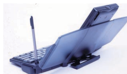
キーボードの下には、引き出し式のステーがあるので安定性は抜群。また、スタイラスを立てておくことができる穴が左右にある
