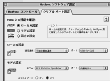
図4 CLIEとHotSyncするには「HotSyncソフトウェア設定」にあるポート欄を「USB for CLIE」に設定する。詳しくは添付のマニュアルを参照
