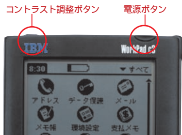
写真5 電源ボタンが少し出ているので、押し込まれる場合がある
