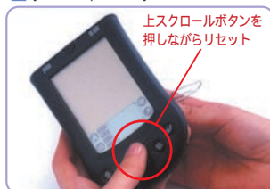
写真3 クールリセット後、再度ソフトリセットで動作確認しよう
