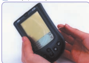
写真2 背面の小さな穴を押すだけ。ソフトやデータは消えない
