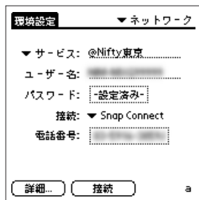
図7 208/209iにつなげるときは電話番号の末尾に「J」を加える
