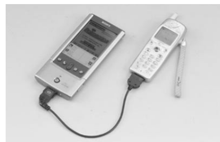
写真 CLIE本体、PEGA-MA510、cdmaOne方式の携帯電話を接続した状態。PEGA-MA510は、CLIEに付属するPEGA-MA500とデザインは同じ
