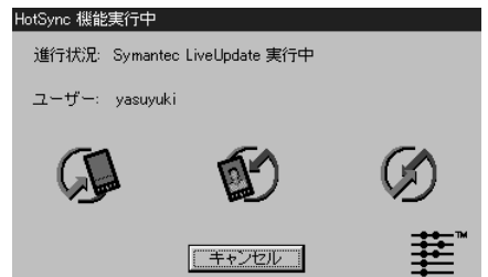
図4 LiveUpdateによる定義ファイルの更新作業はHotSync時に自動的に実行されているので、ユーザーはあまり意識することはない
