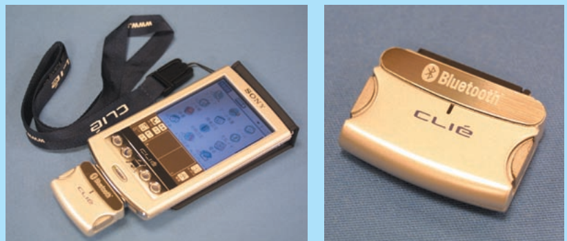
写真3,4 CLIEの「コミュニケーションアダプター」と同じように、電源はCLIEから供給される。写真は開発途中のものなので、製品ではデザインが可能性がある。価格も未定
