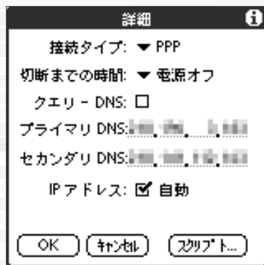
図2 「環境設定」の「詳細」での設定。「接続タイプ」は「PPP」にしておく
