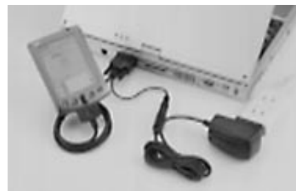
写真1 Palmデバイス、パソコン、トラベルチャージャーを接続したところ。これで、HotSyncケーブルと充電ケーブルを差し替える手間がなくなる
