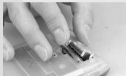
写真2 カバー部の金属部がもろく、力を入れると折れ曲がる可能性があるため、取り付けは慎重に。左図のように取り付けるといい
