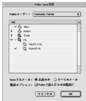
図1 Palmの「メール」と同期するメールボックスを任意に選べる。階層下にあるメールボックスの選択にも対応している。HotSyncは「未読のみ」「すべて」と設定できる
