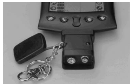
写真3 CLA/DCチャージャーをPalmデバイスに装着した状態。シガーソケット用ケーブルを接続すれば車内でも充電可能だ
