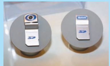
写真2 Palm Sourceで公開されたBluetooth内蔵SDカード 次期Palmに搭載されるSDカードスロットに合わせて、SDカードタイプのモジュールが公開された。その中もしっかりとBluetoothカードもあった。(写真右。左はデジカメ)
