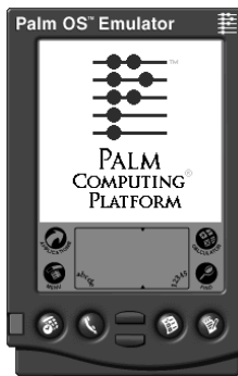
図3 マックでは「File」メニュー、ウィンドウズでは右クリックメニューにある「Save Screen」を実行すると、その時点でのPOSEの画面(液晶表示エリア)を保存できる
