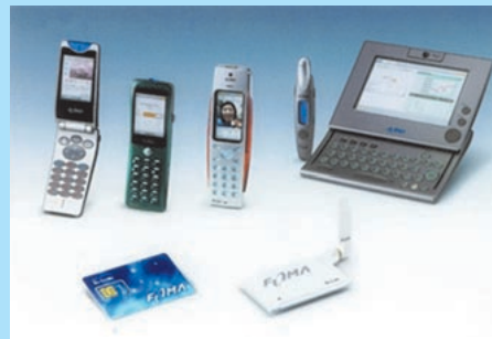
写真1 NTTドコモの次世代携帯電話FOMA（フォーマ）移動時最大348kbps/固定時2Mbpsの高速な通信速度を実現する。それを生かして電話機以外の機能（ビジュアルホン／音楽配信／データ通信）も充実される。今年5月からサービス開始の予定
