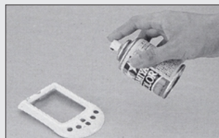
写真3 スプレーで塗装する場合、20~30cmほど距離を置いて、2~3回の重ね塗りをするといい。風通しのいい室外で行おう
