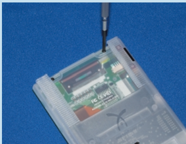
背面にある4本のねじを外す。写真では通常のドライバーを使っているが、スタイラスの頭のプラスチック部分に仕込まれている専用のプラスチックドライバーで十分だ
