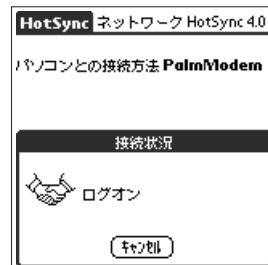
図3 ログイン画面を見てのとおり、PalmデバイスはMobile Docksをモデムとして認識しネットワークへアクセスしているのがわかる
