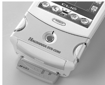
写真 アダプター中央の丸いボタンにメールソフトやウェブブラウザなどを割り当てておけば、ボタンひとつで起動できて便利。装着したC@rdH*64petitはアダプターから約16mmほど下に突き出る
