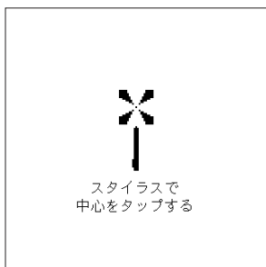
図2 デジタイザーの調整は、図に示されているマークの中心を実際にタップすることで行う。毎回マークの位置が変わり、それを3回ほど繰り返す
