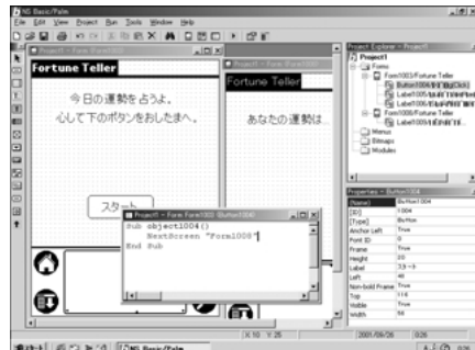
図1 ボタンなどの部品を画面上にレイアウトし、その場で挙動を定義する。GUIとコードの結び付き方を直感的に理解できる
