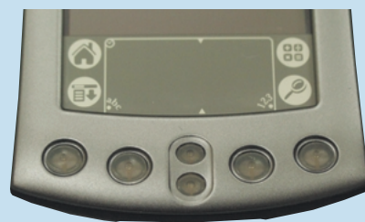
半透明タイプのボタンに交換するだけで、イメージはがらっと変わる。デザイン意匠の問題で、残念ながらボタン上のシルク印刷はされていない
