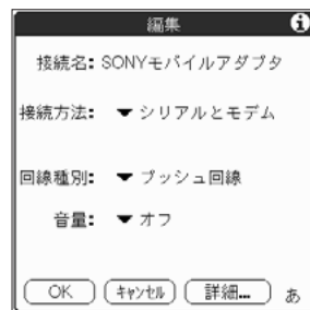
図1 PEG-N700Cの接続設定。「環境設定」の「接続」で「SONYモバイルアダプタ」を図のように設定する。「詳細...」で「速度」が「57,600bps」、「コマンド」が「AT&FX4」であることを確認する
