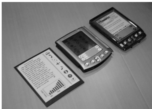
写真1 左から電源を切った状態の電子ペーパー、m 500、Palm IIIポディーに組み込んだ電子ペーパー。m 500は画面を斜めから見ると視認性が悪くなってしまうが、電子ペーパーは文字やアイコンがくっきりと認識できる
