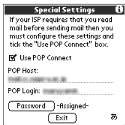
図4 契約プロバイダーによっては、SMTPサーバーの利用にユーザー認証が必要な場合もある。その際はPOPアカウントとパスワードを設定する
