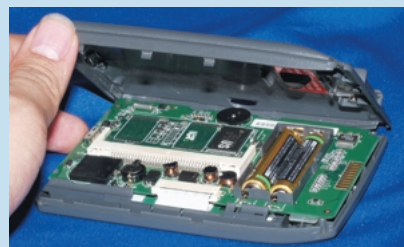
ボディーを固定している爪は、クレジットカードのような弾力性のあるプラスチック板で押し込んでやると簡単に外れる。爪を折らないように注意
