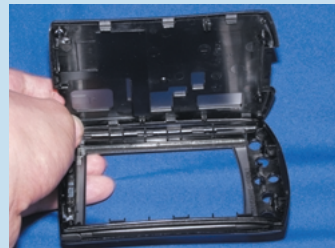
本体上部のSDカードスロット付近の隙間から、クレジットカードなどで中の爪を押し込むような感じで持ち上げて外す
