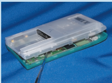
ボディの背面側のふたを少し指で押し込んで、側面を留めている左右4つずつ、計8つの爪を外す。ほかの機種と同じく、クレジットカードなどで補助するとい
