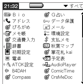
図2 「名前」表示にすると、上図のようにランチャー画面で1画面に最高22個のソフト名と小アイコンが表示できるようになる
