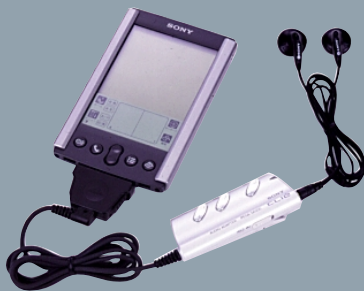
写真 リモコンユニットは、N750C付属のものよりふた回り大きい。スイッチ類はほぼ同じ機能が搭載されている
