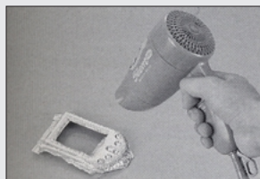
写真2 カッティングシートに熱を加えると、m100のような丸みを帯びたボディにもしっとりとなじんでくる(左)。このほかにも家庭用の壁紙といった素材を使ってm100を木目調にするのも趣があつていい
