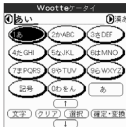
図 Wootteケータイの操作画面。携帯電話のボタンを模したインターフェースに、画面下部にある各ボタンの機能はそれぞれハードボタンに割り当てられている
