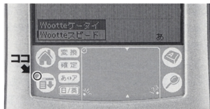
写真 WootteはDAソフトのため、山田達司氏の「DA Launcher 4.0b6」が付属する。「メニュー」アイコンの左上(囲み部分)をタップしてWootteを呼び出す
