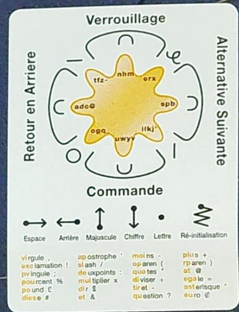
Pour entrer un mot, faites glisser le stylet successivement dans les points de l'étoile correspondant aux lettres qui forment le mot, sans lever le stylet. Au fur et à mesure que vous passez d'une pointe à une autre, Octave propose le mot le plus probable en fonction de la séquence des points visités. Dès que le mot désiré apparaît (parfois même avant la fin de la saisie de toutes les lettres), il suffit de lever le stylet pour
